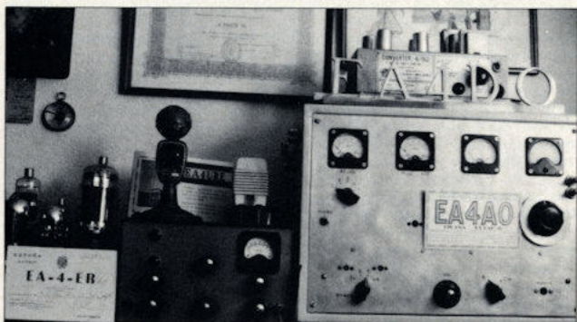
Transmisores de 2 metros (AM y CW) que operaban a cristal. El de la izquierda, de 5 W, construido por EA4ER, utilizado a bordo de la primera estación móvil española: «EA4URE/m». El de la derecha, construido por EA4A0, de 60 W, con fuente de alimentación independiente de 25 kg, similar al que llevamos a Somosierra. Encima de él, puede verse el convertidor de 28/144 MHz.
