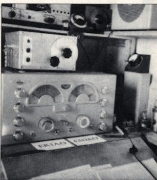
Equipo de Jesús Martín-Córdova en Tánger, 1951 (EK1AO y posteriormente CN2AO). Abajo: receptor multibanda «National NC 183», en el centro conversor para 144/146 y en la parte superior el emisor para 144 MHz, de 50 W, con una QEO6/40.
