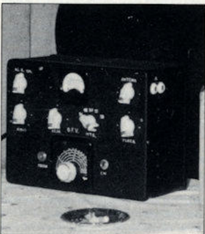
Transmisor de HF «Gehisa», de 50 W, construido por EA4DY y utilizado en Somosierra para la preparación de citas en VHF.
