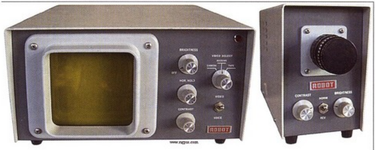
Monitor y cámara ROBOT de un equipo de televisión de barrido lento, SSTV, que comenzó a emplearse entre los aficionados a partir de 1970
