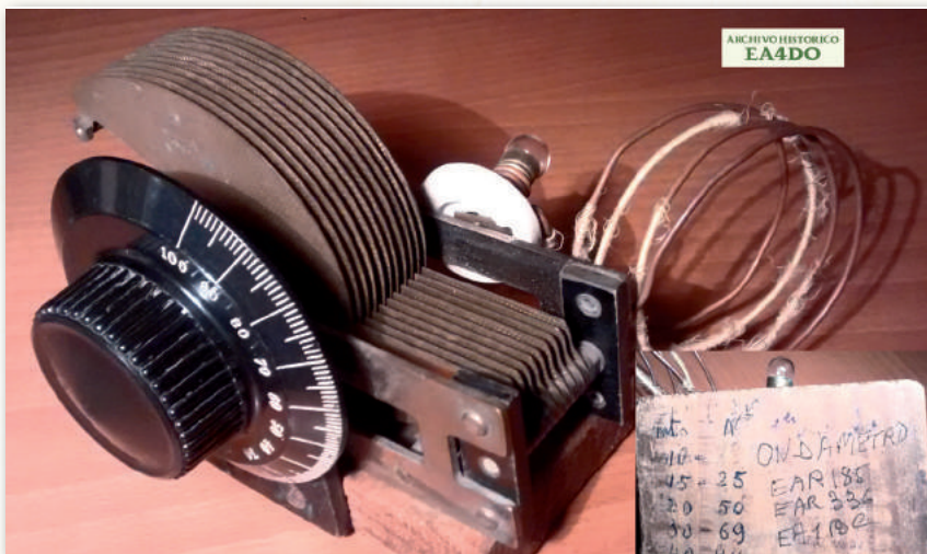
Ondámetro de las estaciones EAR-185 y EAR-336 de los Hermanos Mairlot. (Colección Alberto Mairlot, EAR-336/ EA1BC)
