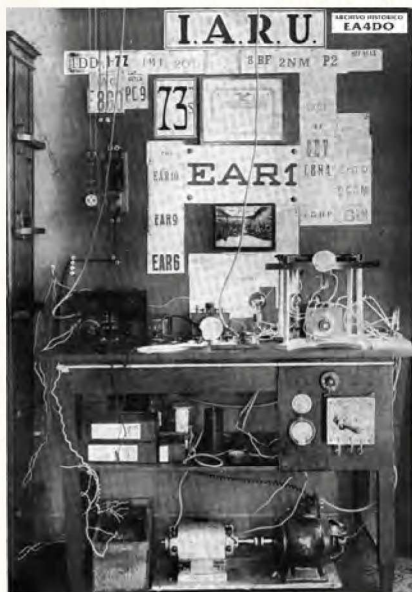
Estación de Miguel Moya constituida por el receptor (izquierda), sistema oscilador (derecha) y dínamo de corriente continua (abajo)
