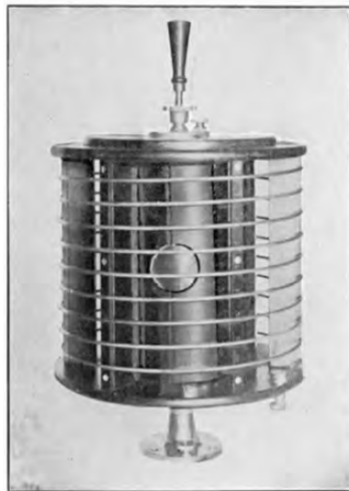
Fig. 6.– Chispero con silenciador, rodeado por la inductancia.
